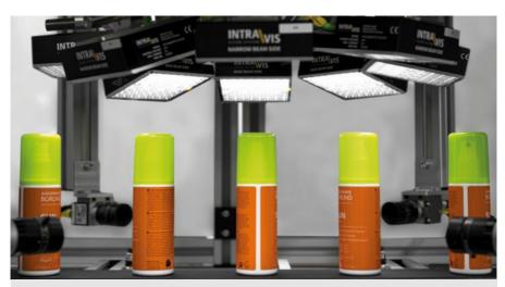
Etikettenkontrolle für unorientierte Objekte - LabelWatcher 360°
