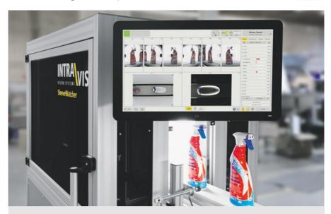
Bildverarbeitungssystem zur Erkennung von sleeve-spezifischen Fehlern
